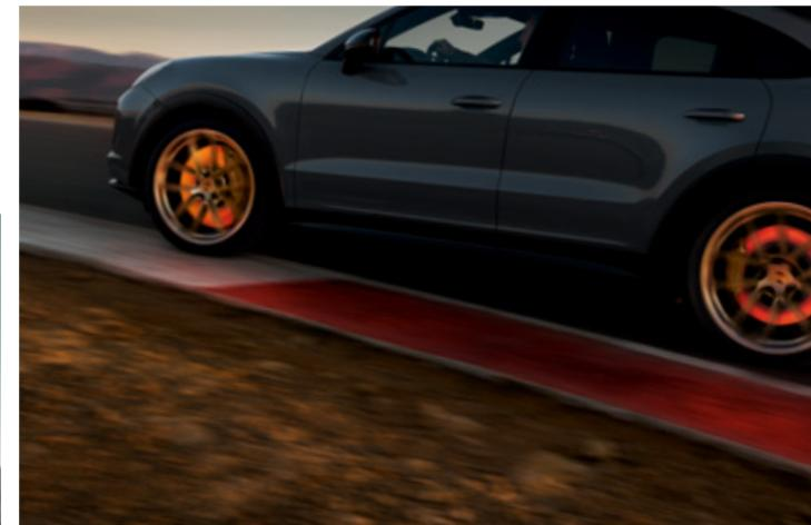
Die **Porsche Ceramic Composite Brake (PCCB)** bietet dank Keramikbrems scheiben mit einem Durchmesser von 440 mm an der Vorderachse und 410 mm an der Hinterachse eine noch höhere Bremsleistung auf der Straße – und im Dauereinsatz auf der Rundstrecke.
