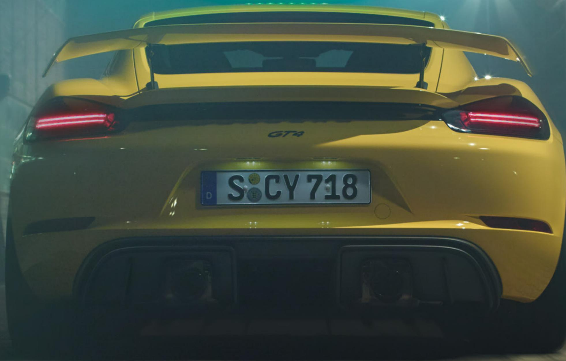
Das Heck wird dominiert von dem feststehenden, jetzt aus einem Teil geformten Flügel mit integrierten Sideblades und Stützen aus Aluminium. Auch er stammt unverkennbar von der Rundstrecke, sorgt für Abtrieb auf der Hinterachse und entsprechend hohe Traktion – nicht nur in der Kurve. Gleichzeitig sorgt er für klare Verhältnisse und signalisiert allen Optimisten, die den 718 Cayman GT4 überholen möchten: Vergiss es.
