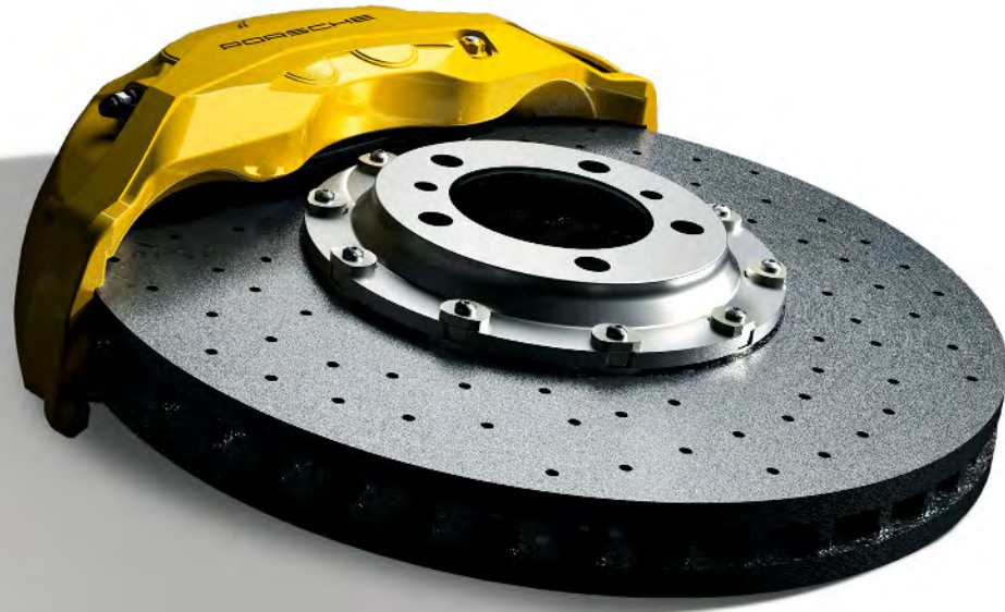
1 Porsche Ceramic Composite Brake (PCCB): Brems Scheibendurchmesser vorn 440 mm, hinten 410 mm
