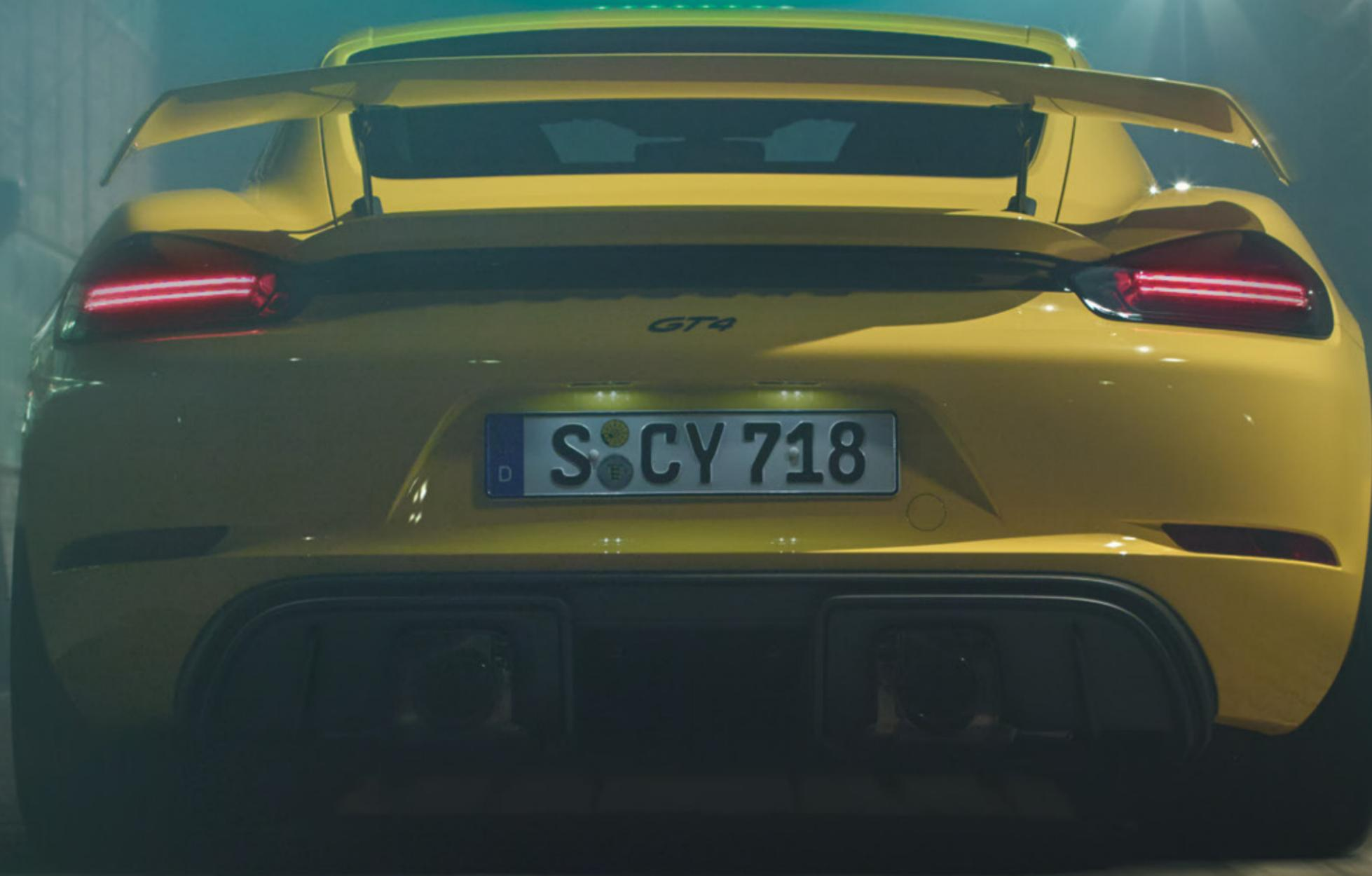
Das Heck wird dominiert von dem feststehenden, jetzt aus einem Teil geformten Flügel mit integrierten Sideblades und Stützen aus Aluminium. Auch er stammt unverkennbar von der Rundstrecke, sorgt für Abtrieb auf der Hinterachse und entsprechend hohe Traktion – nicht nur in der Kurve. Gleichzeitig sorgt er für klare Verhältnisse und signalisiert allen Optimisten, die den neuen 718 Cayman GT4 überholen möchten: Vergiss es.
