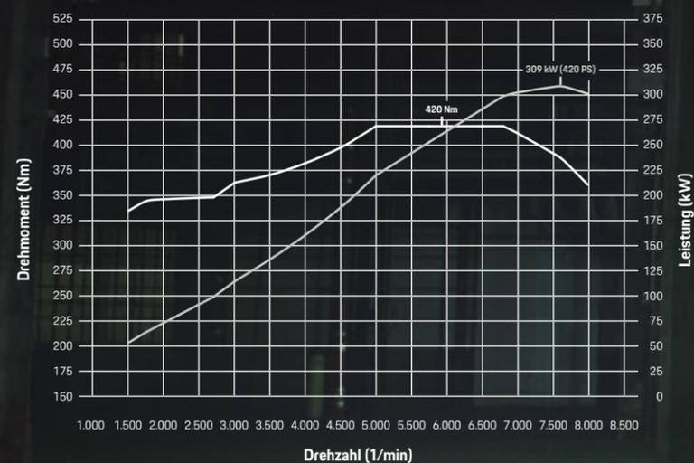
718 Cayman GT4: 309 kW (420 PS) bei 7.600 1/min, 420 Nm zwischen 5.000 und 6.800 1/min
